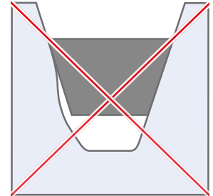
Polia de correia em v desgastada
